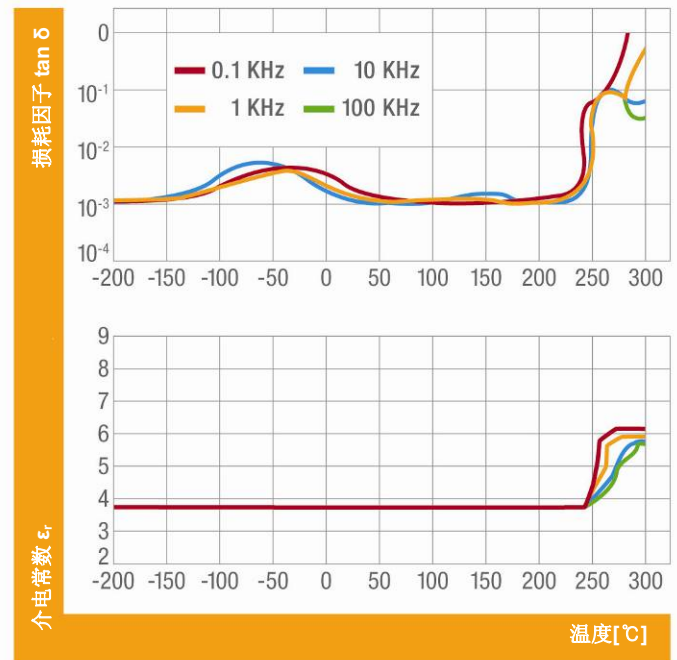
图 40: Ultrason® E2010 的介电损耗因子 \tan \delta 和介电常数 \epsilon_r 对温度取函数
