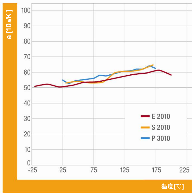
图 24: 根据 DIN 53752 的线性热膨胀系数
