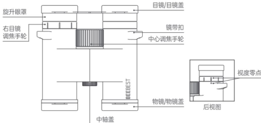
注意：逆时针拧下中轴盖，可连接转接支架及脚架使用。
